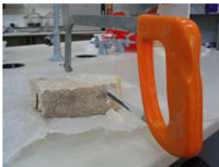
תרשים 3-3: ניסור והכנה של דגם יחידת חול לבדיקת גזירה ישירה.
