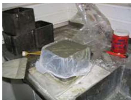
תרשים 3-4: יציקת הבטון לקופסת הפלדה התחתונה. משמאל: דגם יחידת החול מוטבע בבטון בכדי לקבל אחיזה טובה.
