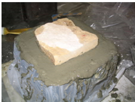
תרשים 3-4: יציקת הבטון לקופסת הפלדה התחתונה. משמאל: דגם יחידת החול מוטבע בבטון בכדי לקבל אחיזה טובה.
