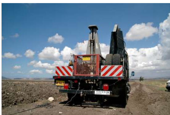
תרשים א: מקור אנרגיה מסוג digipulse של המכון הגיאופיסי לישראל. הפטיש המכה בקרקע מורכב על משאית קטנה המתקדמת מתחנה לתחנה לאורך קו המדידה.
