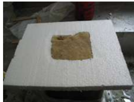
תרשים 3-6: הכנת המדגם ליציקה עליונה. מימין: הדגם מוקף בקלקר על מנת ליצור הפרדה בין הקופסא התחתונה לעליונה. משמאל: הדגם מוכן ליציקת הקופסא העליונה.
