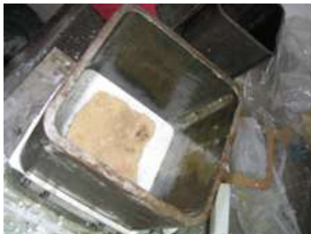
תרשים 3-6: הכנת המדגם ליציקה עליונה. מימין: הדגם מוקף בקלקר על מנת ליצור הפרדה בין הקופסא התחתונה לעליונה. משמאל: הדגם מוכן ליציקת הקופסא העליונה.
