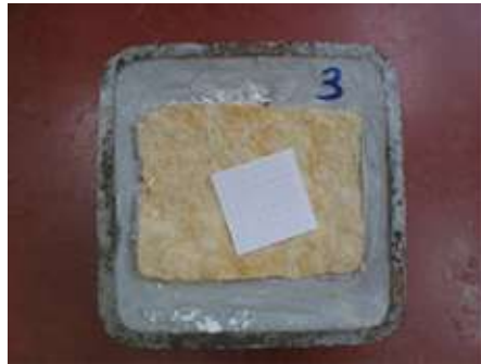
תרשים 3-5: דגם של יחידת חול מצולם לצורך מדידת שטח (לאחר הגזירה).
