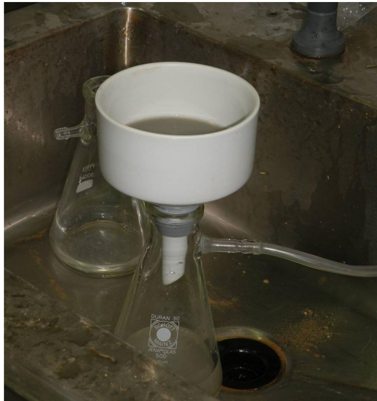
איור 4.4: שטיפת דוגמאות במשפך. נייר סינון מונח בתחתית המשפך ומשאבה שואבת את המים בעוד הדוגמה נשארת במשפך.
