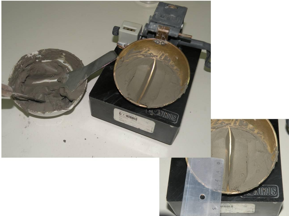
איור 4.6: בדיקת גבול נזילות. הדוגמה נחרצה למעלה בחורץ. לאחר מספר הקשות החריץ נסגר לאורך של כ-13 מ"מ, למטה.
