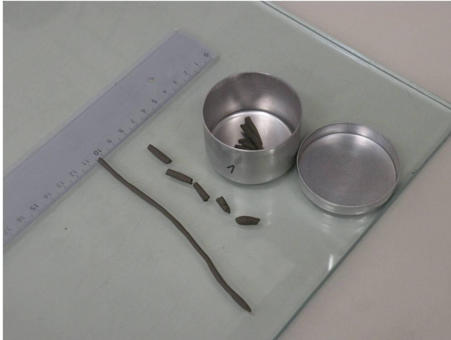
איור 4.5: בדיקת גבול פלסטיות. ה"צינור" מגולגל בלחיצה עדינה עד שהוא מתפרק למספר חלקים.
