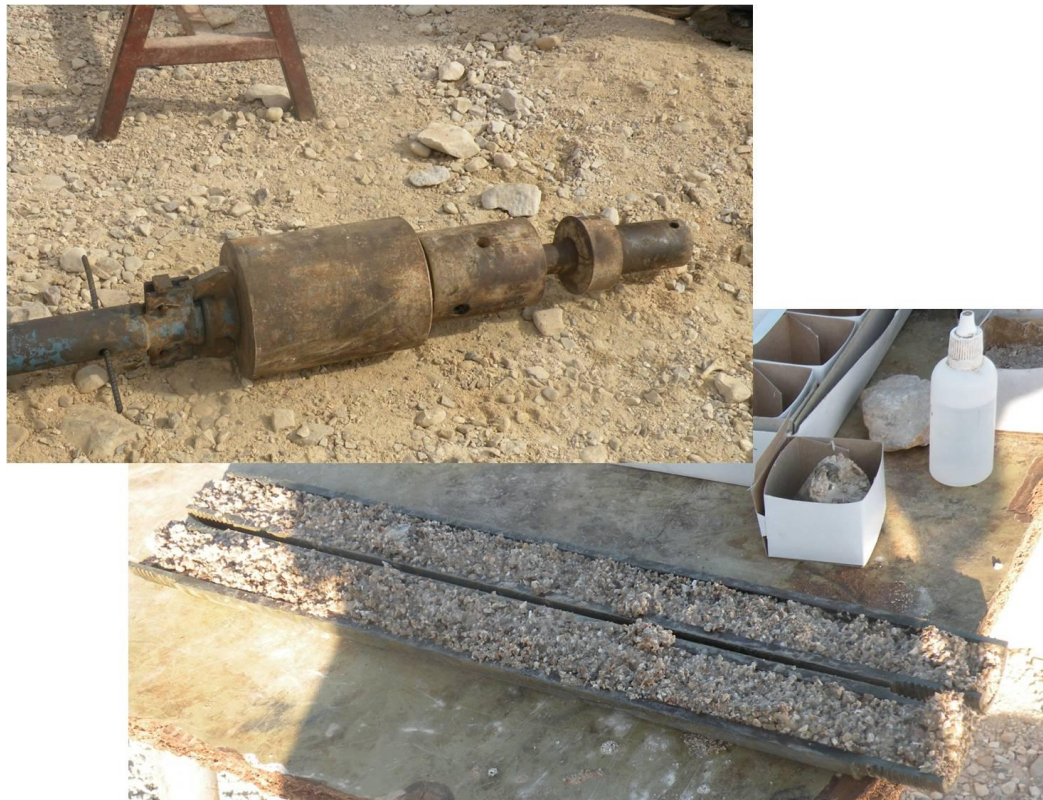
איור 4.2: ציוד בדיקת SPT. למעלה הפטיש, הסדן והמוט שלאורכו נופל הפטיש. למטה צינור הבדיקה לאחר פתיחתו עם דוגמת חומר מתוך חור הקידוח
