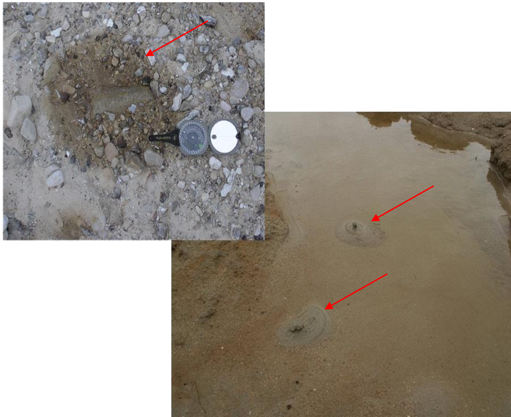
איור 1.2: עקבות בעבוע חול בתוך שלולית, סימן להתנזלות. סימני רטיבות מסביב לחלוק נחל מעידים על עליית מים בלחץ גבוה מלמטה, תופעה הגורמת להתנזלות. צולם לאחר הרעידה בים המלח ב-2004.
