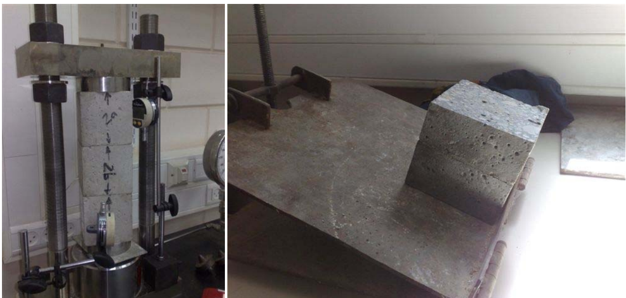
תמונה 7. בדיקת הטיה על גושי בטון בגודל 5/10/10 \text{ ס"מ} (צד ימין) ובדיקת לחיצה חד צירית של שלושה בלוקים בגודל 10/10/10 \text{ ס"מ} (צד שמאל).
