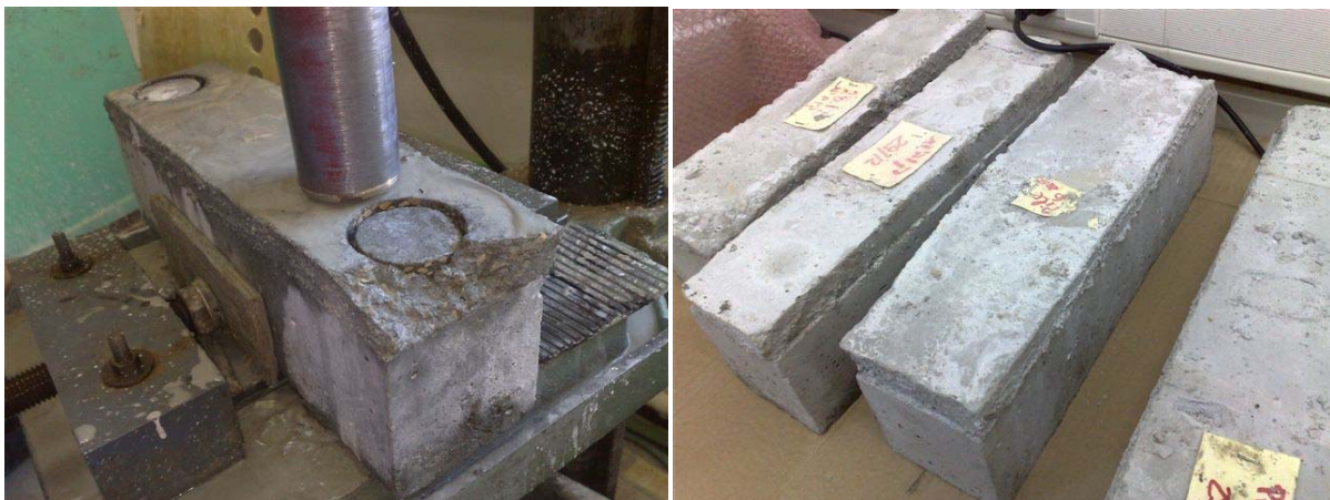
תמונה 5. גושי בטון בגודל 40/12/10 ס"מ (צד ימין) ותהליך הוצאת הגלעינים (צד שמאל).
