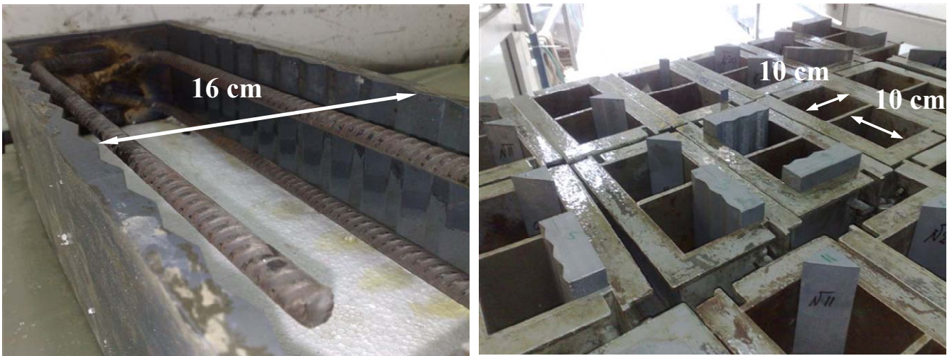
תמונה 2. פלטות תותבות מ-PVC בתוך התבניות ליציקת בלוקים (צד ימין) ותבנית ליציקת כלונס (צד שמאל)
