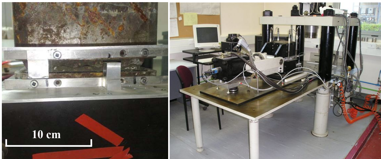
תמונה 6. מכש הידראולי לגזירה ישירה מתוצרת Terra Tek Inc. דגם DS – 4520 (צד ימין), ממשק מחוספס כלונססלע מלאכותי לפני הבדיקה (צד שמאל).
