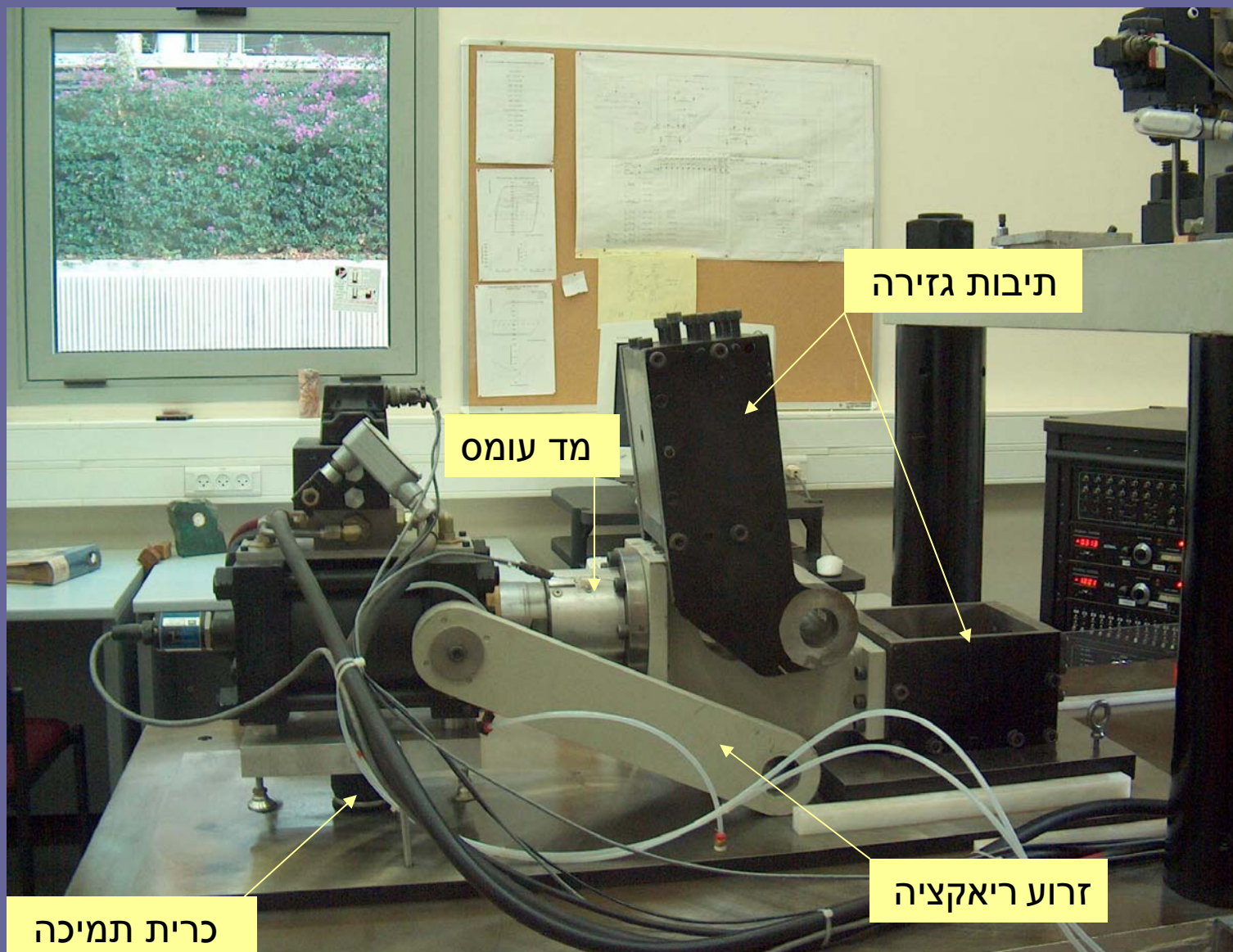
תרשים 14: מכלול בוכנת הגזירה וקופסאות הגזירה הצמודות אליה.
