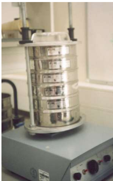
תרשים 4.12. מתקן לניפוי מדגמי הקרקע דרך נפות סטנדרטיות.
