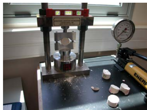
תרשימים 3.1 ו-3.2: מכש ידני לקביעת תכונות אינדקס (מימין) ומכש הידראולי לבדיקת לחיצה חד-צירית (משמאל)
